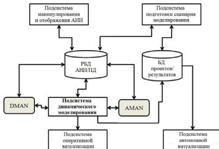
Рис. 2. Структурная схема исследовательского комплекса АНИ/ПД – АНИ и полетные данные, РБД – распределенная БД
