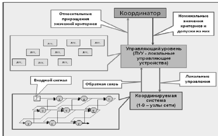
Рис. 1. Упрощенная схема децентрализованной системы управления сетью объектов
