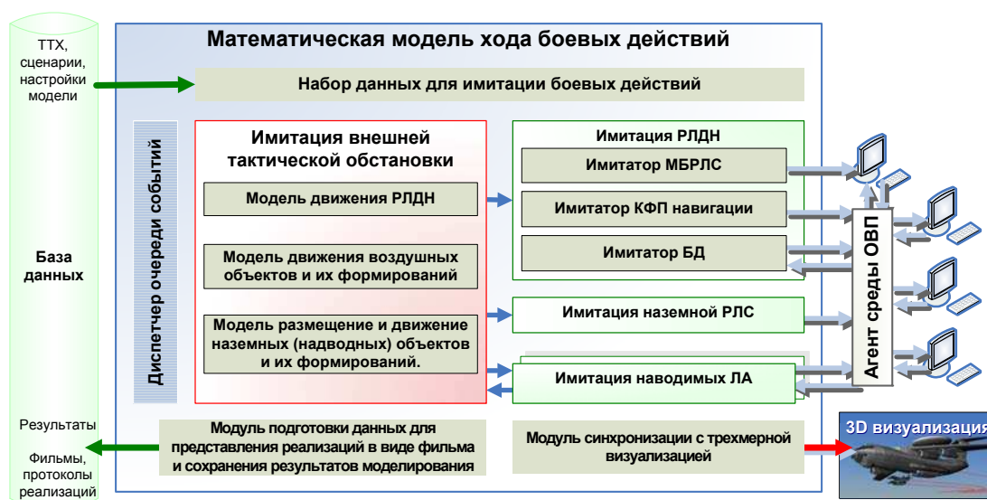
Рис. 2. Организация вычислительного процесса в случае воспроизведения разведывательно-ударных фронтовых операций и боевых действий с участием самолета РЛДН
