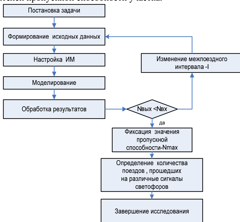
Рис. 2. Методика оценки пропускной способности участков железных дорог
